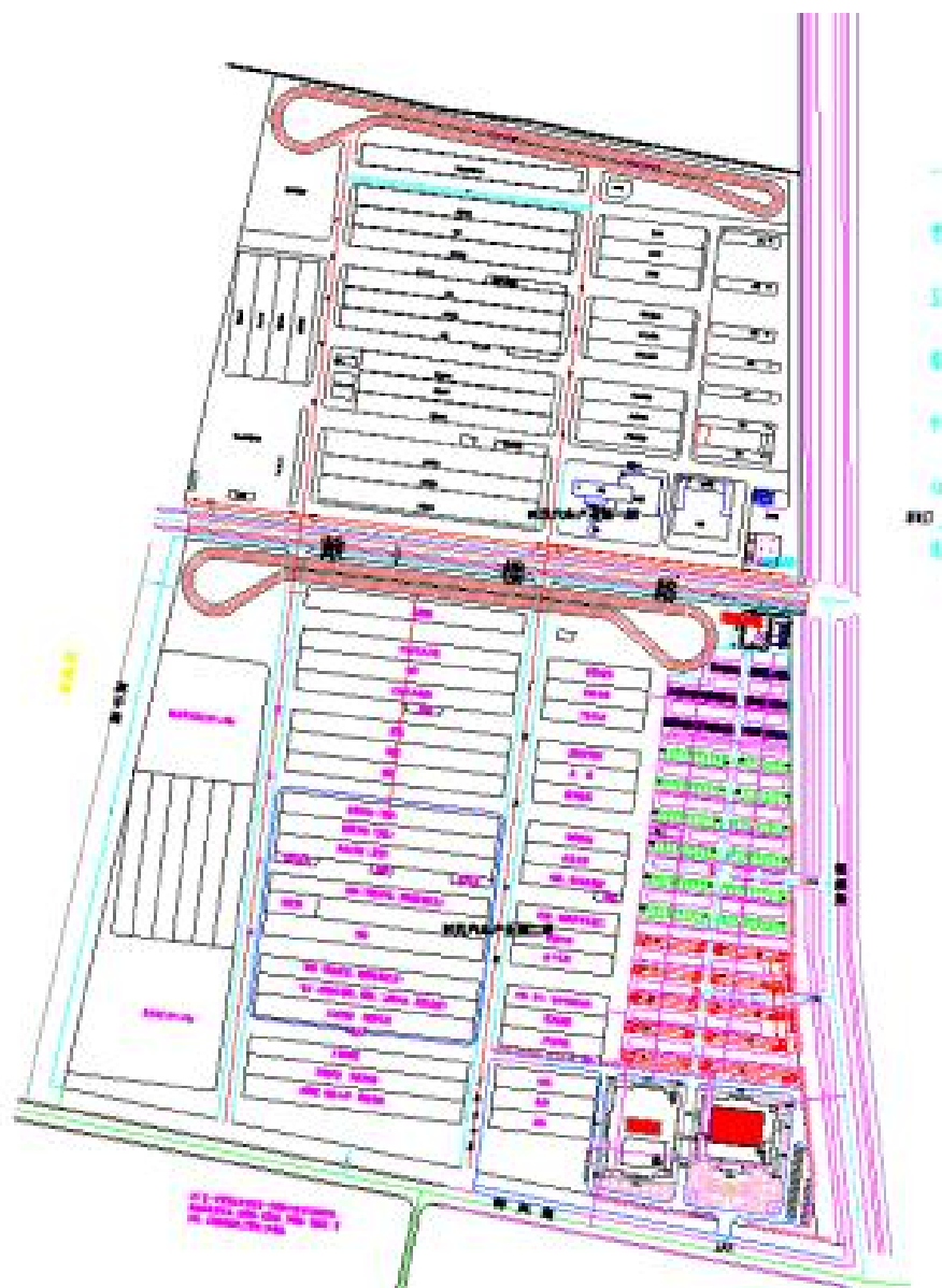
附图 6: 厂区雨污管网图
